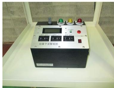
結露予測警報器「露助(ツユスケ)」を搭載すれば1時間先の結露予測を警報ランプでお知らせいたします。
